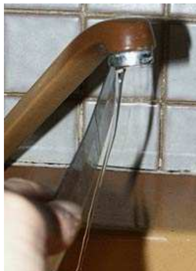
Expérience de déviation d'un filet d'eau par une règle électrisée
